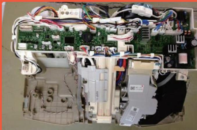
長年のご使用で、製品内部漏水、洗剤、小水等の影響で部品の腐食が進んでいます
