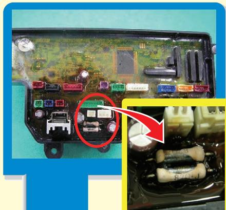
電子・電気部品が被水し発熱
