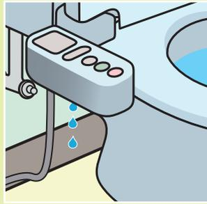
製品から漏れている水が少量であっても、製品内部では多量の水が漏れている場合があります。
